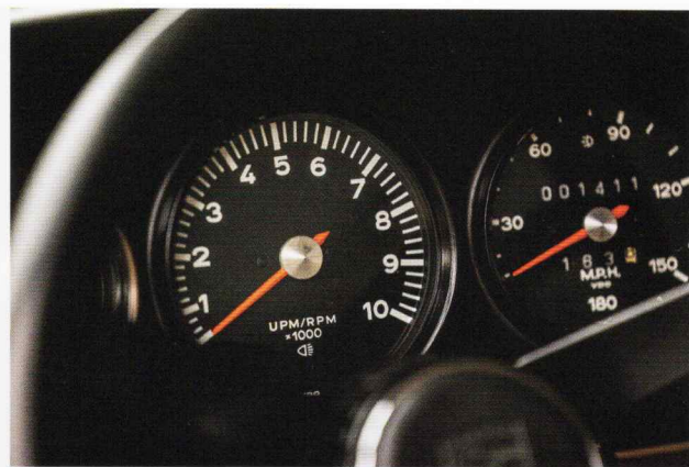
タコメーターは10000rpmスケール。レッドゾーン表記はないが、リミットは7000rpmだ
