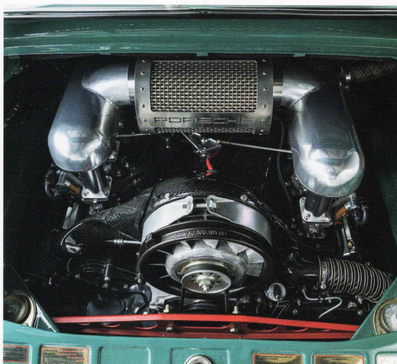
見た目からしてカッコいいエンジンルーム。エンジンは930カレラ3.2用ユニットをベースにボアアップして3.4ℓへ。さらに、ツインプラグ化してある。エンジンコントロールは、930カレラ3.2純正ジェトロニックではなく、AEM製ECUを採用した。マーク・ズーリンデン氏によれば、この仕様により300psを発するとのこと
