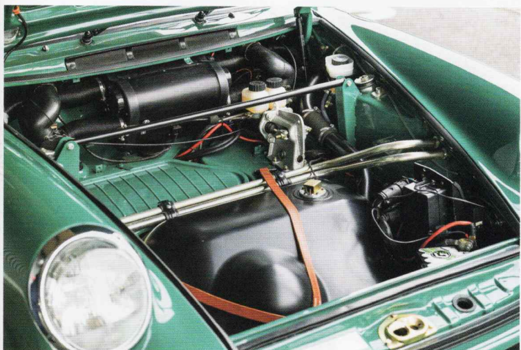
ガソリンタンクは100ℓ仕様。その上に、荷物を固定するための革バンドが備わる。ガソリンタンクの上に見える金色の二本のパイプは、左右フロントフェンダー内にあるオイルクーラーを結ぶオイルラインだ。ストラットタワーバーを装備。ブレーキマスターシリンダーがツインに強化されていることが分かる
