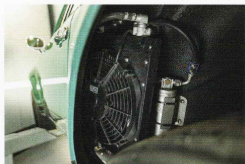
左リアフェンダー内には、エレクトリックエアコンのコンデンサー(手前に大きなファンが見える)とリキッドタンクを備える
