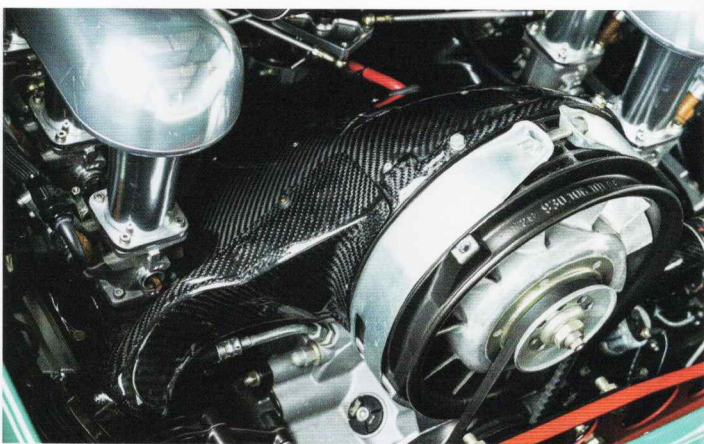
見た目からしてカッコいいエンジンルーム。エンジンは930カレラ3.2用ユニットをベースにボアアップして3.4ℓへ。さらに、ツインプラグ化してある。エンジンコントロールは、930カレラ3.2純正ジェトロニックではなく、AEM製ECUを採用した。マーク・ズーリンデン氏によれば、この仕様により300psを発するとのこと
