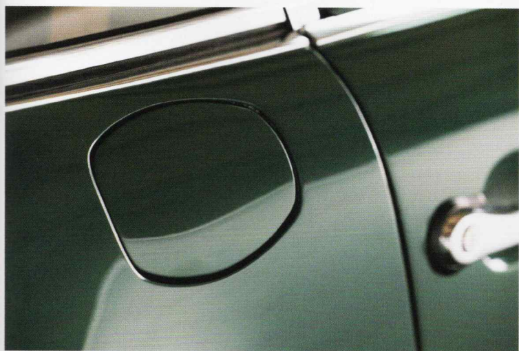
1972年式911Tをベースにしているため、右リアフェンダーにはその年式のみの特徴であるオイルリッドがある
