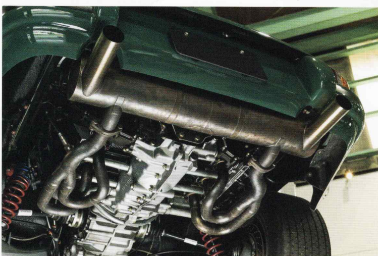
2本出しマフラー。ヒートエクスチェンジャーがないことに気づくだろう。つまり、ヒーターがないということだ
